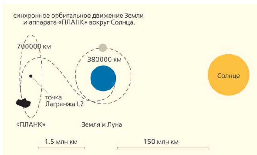
Рис.2. Траектория аппарата «ПЛАНК» при выходе на расчетную орбиту.
